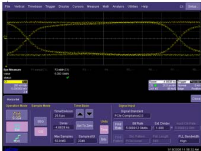
图9，用采样示波器测量5Gbps眼图
